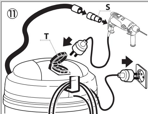
**IT** 2-Verbinden Sie den Stecker des Elektrowerkzeugs an der Steckdose **T** des Nass- und Trockensaugers
