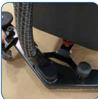
Tergipavimento rinnovato con un nuovo sistema di regolazione della pressione. Le lame terqipavimento sono facilmente sostituibili senza l'utilizzo di attrezzi. Il terqipavimento si sgancia senza danneggiamenti in caso di impatto accidentale.
